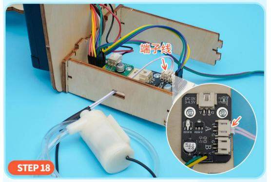
首先把②号板安装到③号板上,然后用7mm粗纹螺丝把 ⑤号板也安装到③号板上,最后把水泵的端子线插到基础 驱动板上的A接口上。
