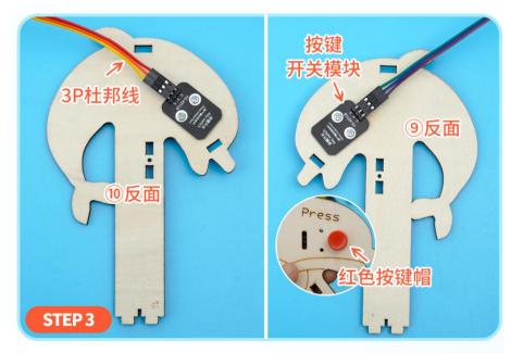
首先用4mm粗纹螺丝把两个按键开关模块安装在⑨、⑩
