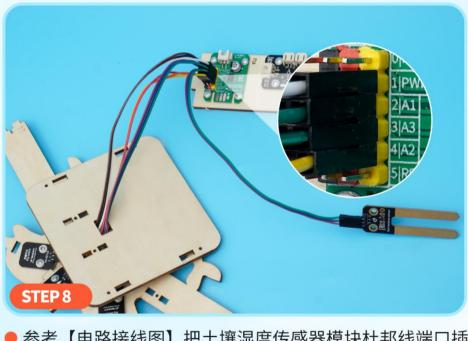
参考【电路接线图】把土壤湿度传感器模块杜邦线端口插 到控制板上的3|A3接口上。注意:请核对好端口线序再插 入,线序插错可能会烧坏电路板。
