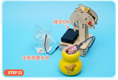
恭喜你,自动浇花系统制作完成! 在电池盒内装入电池,然后把土壤湿度传感器和软管插入 土壤里,最后把电池盒的开关拨至ON方向,自动浇花系统就 可以开始工作了。注意:OFF表示关闭,ON表示打开。
